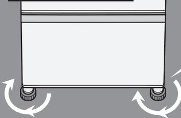
Поворачивать регулировочные ножки, пока они не коснутся пола, а передние ролики не оторвутся от поверхности, после чего зафиксировать.
