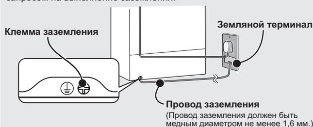
**При отсутствии клеммы заземления**
